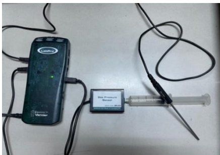
Fig. 4.1- Dispozitive folosite în activitatea experimentală pentru studiul transformării izoterme a unui gaz
